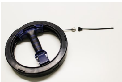
Abb. 15: Schubstange auf Haspel schrauben
