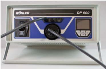
Abb. 24: Anschluss von Druck- und Luftschlauch an das Wöhler DP 600
