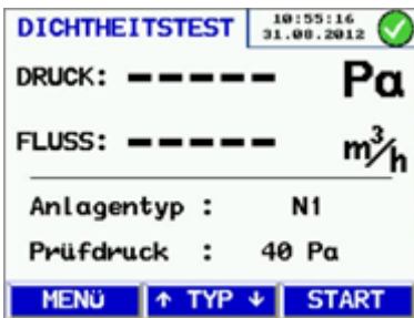
Abb. 38: Dichtheitsprüfung an Anlage Typ N1
