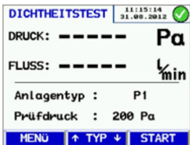
Abb. 39: Dichtheitsprüfung an Anlage Typ P1
