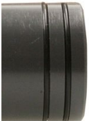
Abb. 30: Verlängerungsrohrende mit schmalen O-Ringen - Sondenanschluss
