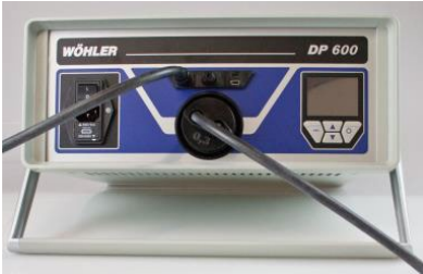
Abb. 25: Anschluss von Druck- und Luftschauch an das Wöhler DP 600
