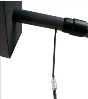
Abb. 32: Verbindung von Sonde und Verlängerungsrohr
