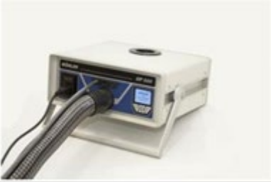
Abb. 63: Anschluss von Luftschlauch und Druckanschlussschlauch an das Wöhler DP 600
