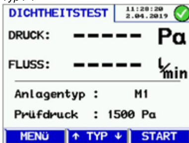
Abb. 40: Dichtheitsprüfung an Anlage Typ M1
