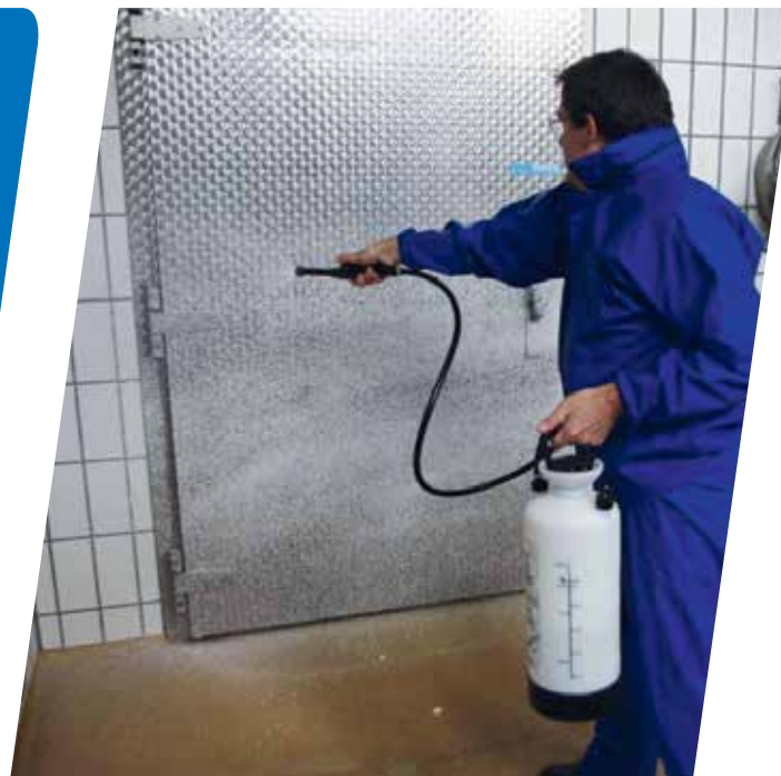
■ Indu-Matic : nettoyeur à mousse avec bouteille sous pression de 20 l, à raccorder à un compresseur séparé.
