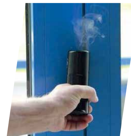
■ Visualisation de courants d'air (pistolet à brouillard)
