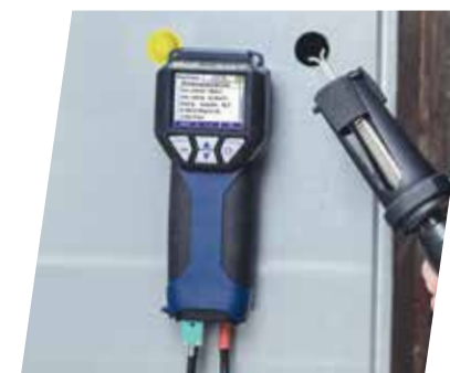
■ Appareils de mesure de la pression différentielle, également pour la mesure très fine de la pression.
